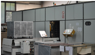
Nettoyage de conteneurs grillagés pour une charge utile de 1 000 kg
